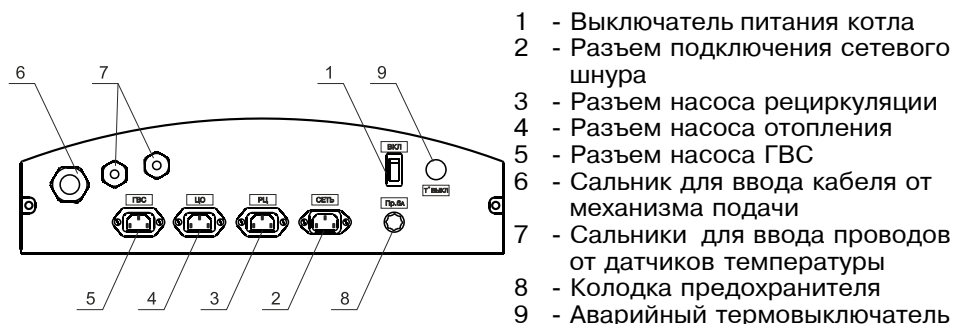
Рис.5 Расположение органов управления на задней панели пульта
