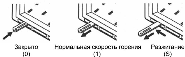
**Рис. 27: Регулировка подачи воздуха Tertio 67 / 670C / 67 VL / 55**
